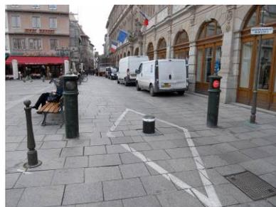
写真1 歩行者空間の入口ではライジングボラードによって自動車交通を抑制している
